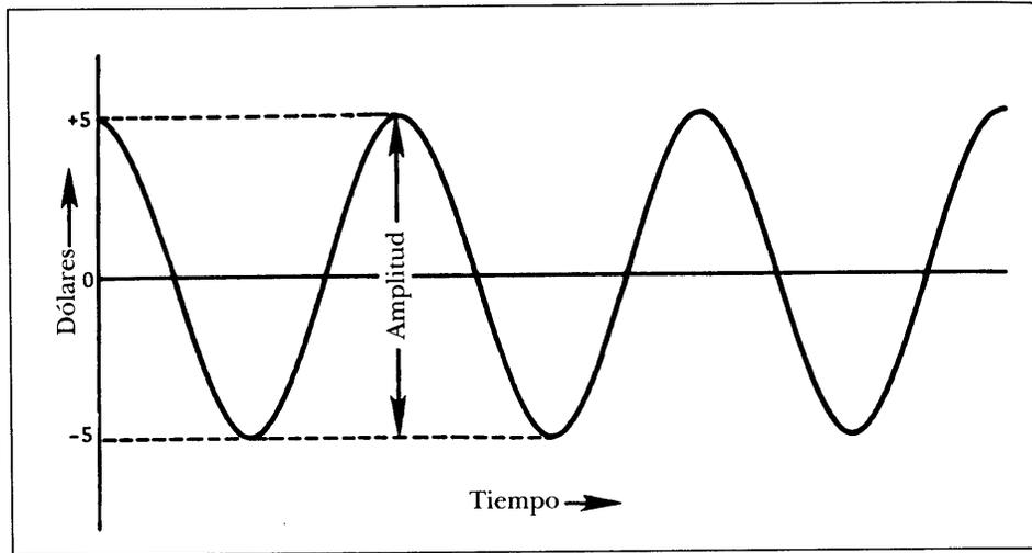
**Figura 14.5** Amplitud de una onda. En esta figura, la onda tiene una amplitud de diez dólares (desde menos cinco dólares hasta más cinco dólares). La amplitud siempre se mide desde el valle hasta la cresta de la onda.
