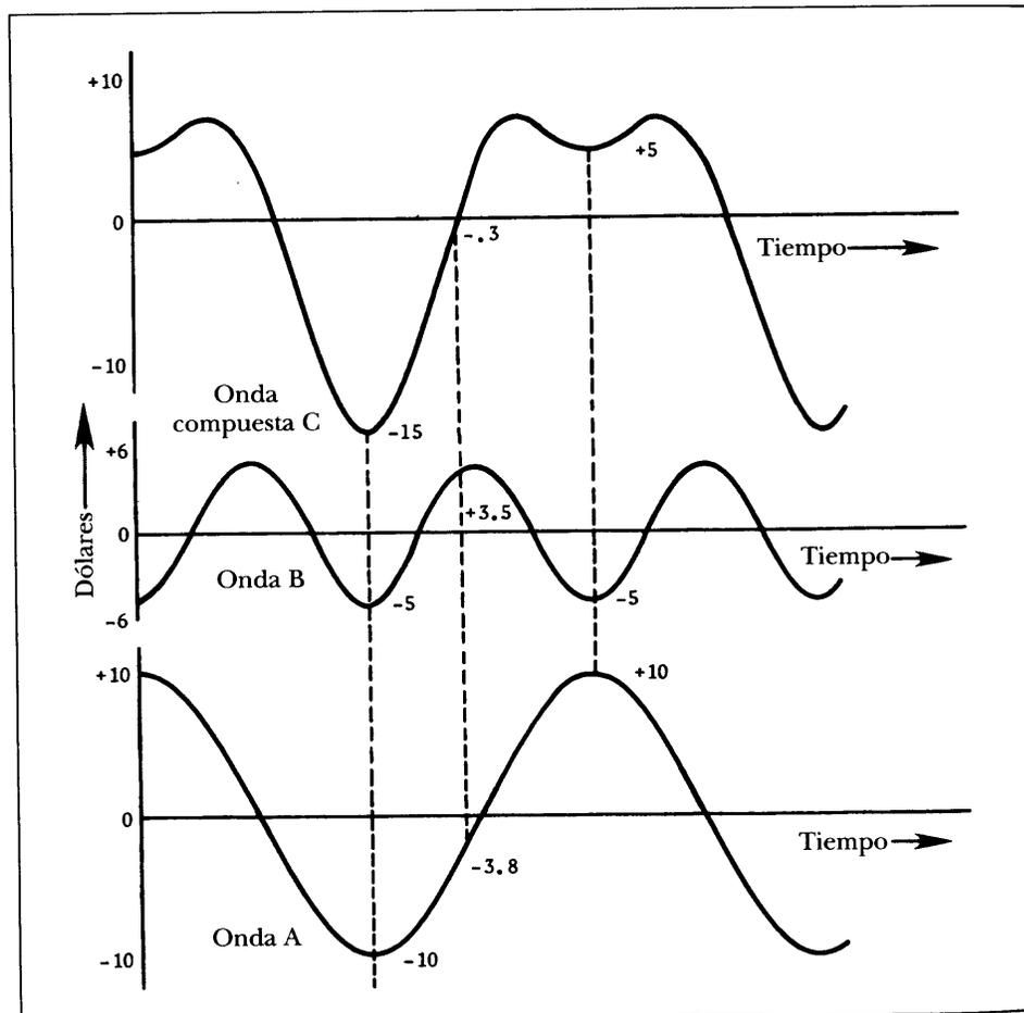
**Figura 14.8** Acumulación de dos ondas. Las líneas punteadas muestran, en cada punto en el tiempo, que el valor de la onda A se suma al valor de la onda B para producir el valor de la onda compuesta C.
